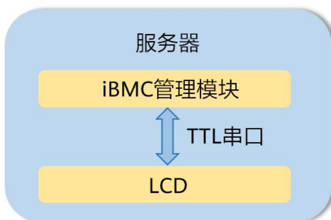
图 5-185 LCD 子系统工作原理
